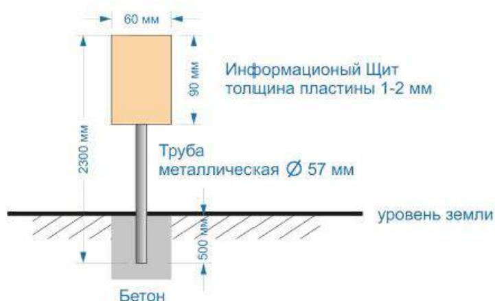
Навигационный указатель – в виде металлической (обработанной оцинковкой) стреловидной пластины (зеленого, желтого, красного цветов) толщиной 1-2 мм и размерами 60х300 мм.
